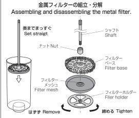
分解の際は、シャフト先端を持ってフィルターホルダーを時計回りに回してください。 When disassembling, please hold the tip of shaft and turn a filter holder clockwise.
